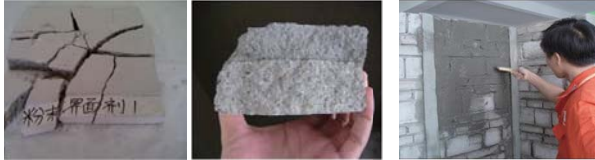
(1) 锤击试验，水泥底板破坏了，砂浆依然粘贴牢固
